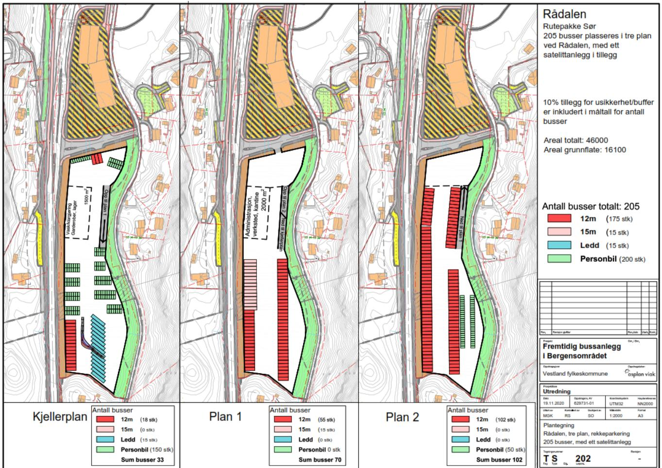
Figur 8-9: Prinsippskisse TS202 med 3 plan for 205 bussar med både bil- og bussparkering i kjellar.
