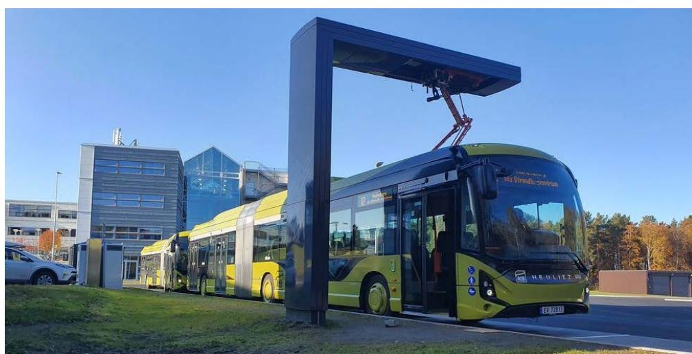
Figur 3-3: Døme pantograf lading (Kjelde: [www.adressa.no](http://www.adressa.no))
