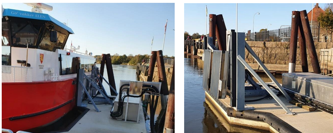
Figur 13 Induksjonslading av byferje i Fredrikstad (foto: Rambøll)
