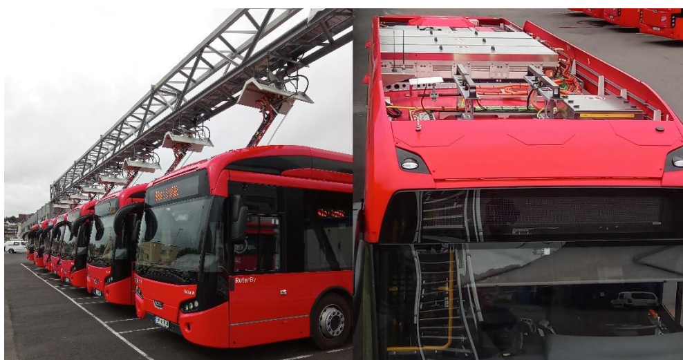
Figur 10 Pantograt (panto-opp) for busser i Oslo. Disse lades med en effekt på 300 kW. Til høyre er buss med mottaksskinne for panto-ned.
