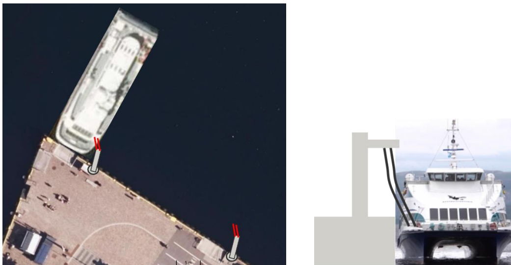
Figur 25 Illustrasjon av ladekabeltårn på fast kai
