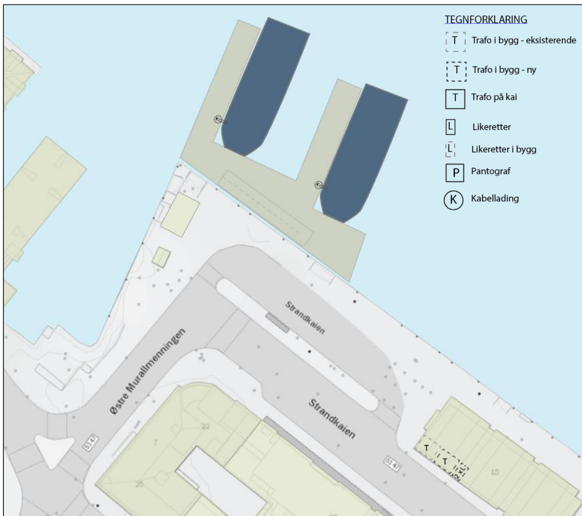
Figur 40 Illustrasjon. Nettstasjoner (gammel og ny) og likerettere, plassert i Strandkai terminalen
