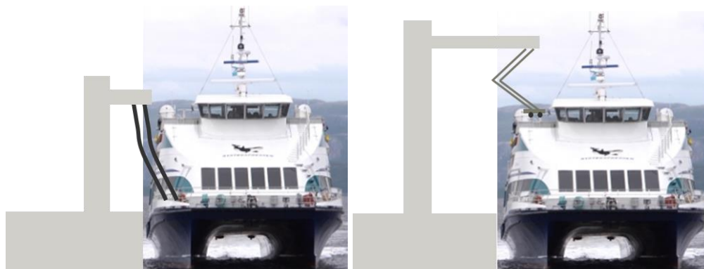
Figur 14 Illustrasjon. Lading med kabel og pantograf
