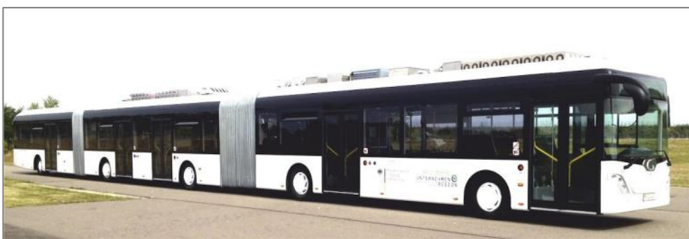
Figur 12. Dobbelleddbuss med kapasitet opp mot 200 passasjerer.
